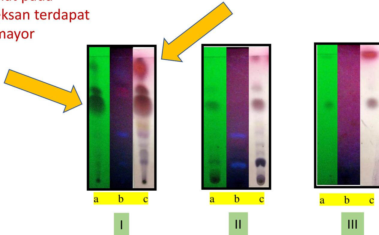
**Gambar 1.** Kromatogram lapis tipis fase diam silika gel F254 , fase gerak Toluene-aseton (9:1), (I) ekstrak heksan, (II) ekstrak etil asetat, (III) minyak atsiri, (a) UV 254nm, (b) UV 366nm, (c) anisaldehyd-as.sulfat, dipanaskan.
