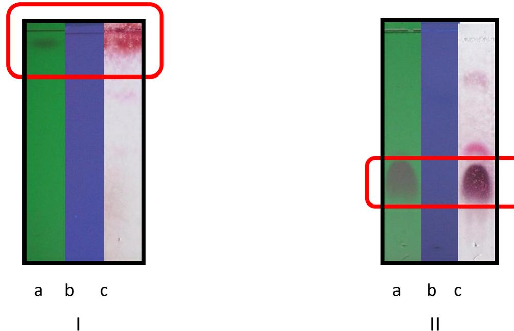
**Gambar 3.** Kromatogram lapis tipis fase diam silika gel F254 , fase gerak heksan-etil asetat (9:1), **(I) fraksi 2, (II) fraksi 5,** (a) UV 254nm, (b) UV 366nm, (c) anisaldehyd-as.sulfat, dipanaskan.
