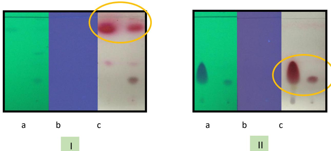
**Gambar 4.** Kromatogram lapis tipis fase diam silika gel F254 , fase gerak heksan-etil asetat (9:1), **(I) subfraksi 1 dengan pembanding minyak atsiri, (II) subfraksi 2 dengan pembanding eugenol standar,** (a) UV 254nm, (b) UV 366nm, (c) anisaldehyd-as.sulfat, dipanaskan.
